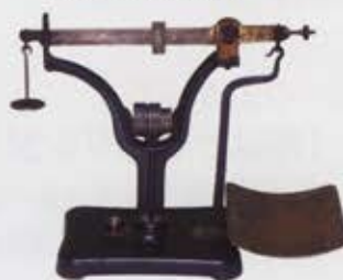
下皿式桿秤 (大正時代) 郵便局で郵便物の質量を量るのに用いられていた秤。
